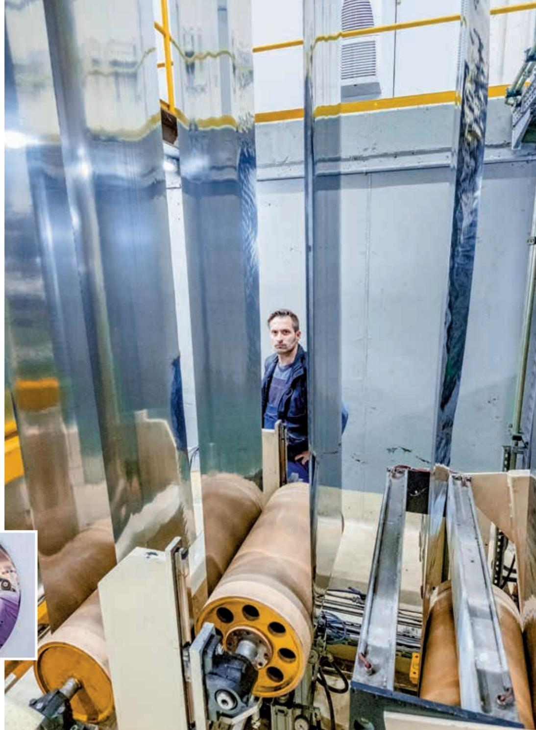
>> folien: „Andere machen Tonnen, wir machen Fläche.“ Die wird hier natürlich nicht an einem Stück in Helgoland-Größe verarbeitet. Bis zu einem halben Meter Breite schafft das 20 Rollen-Walzgerüst: Eine Acht-Stunden-Schicht braucht es, bis aus beispielsweise 0,3 Millimeter dickem Stahl 0,04 Millimeter werden.
